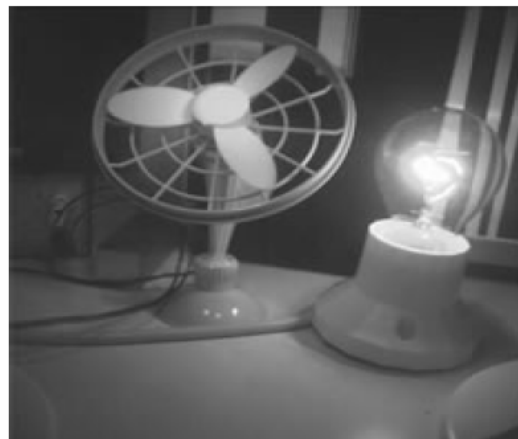
图 4 用 Linlog 技术拍摄的高速旋转的电扇图像
