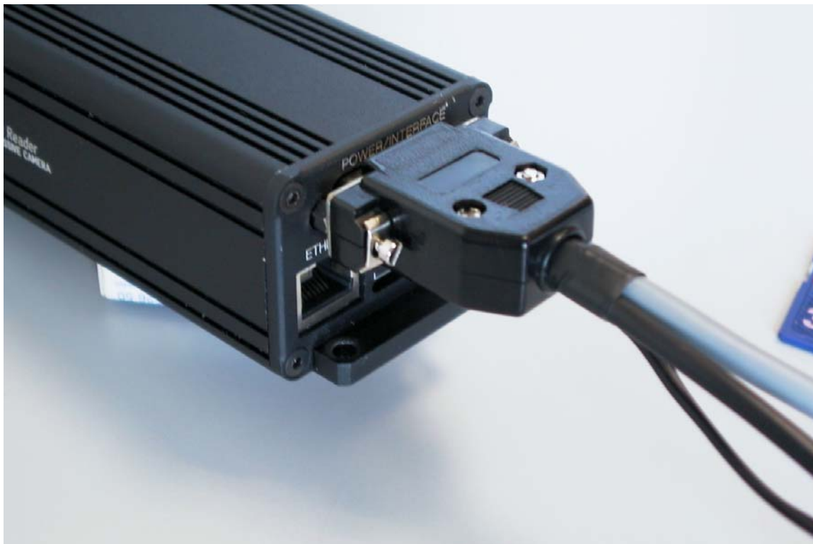
如图连接电源和数字 I/O 线缆，连接器为 D-sub 类型，阳极为引脚 15。
